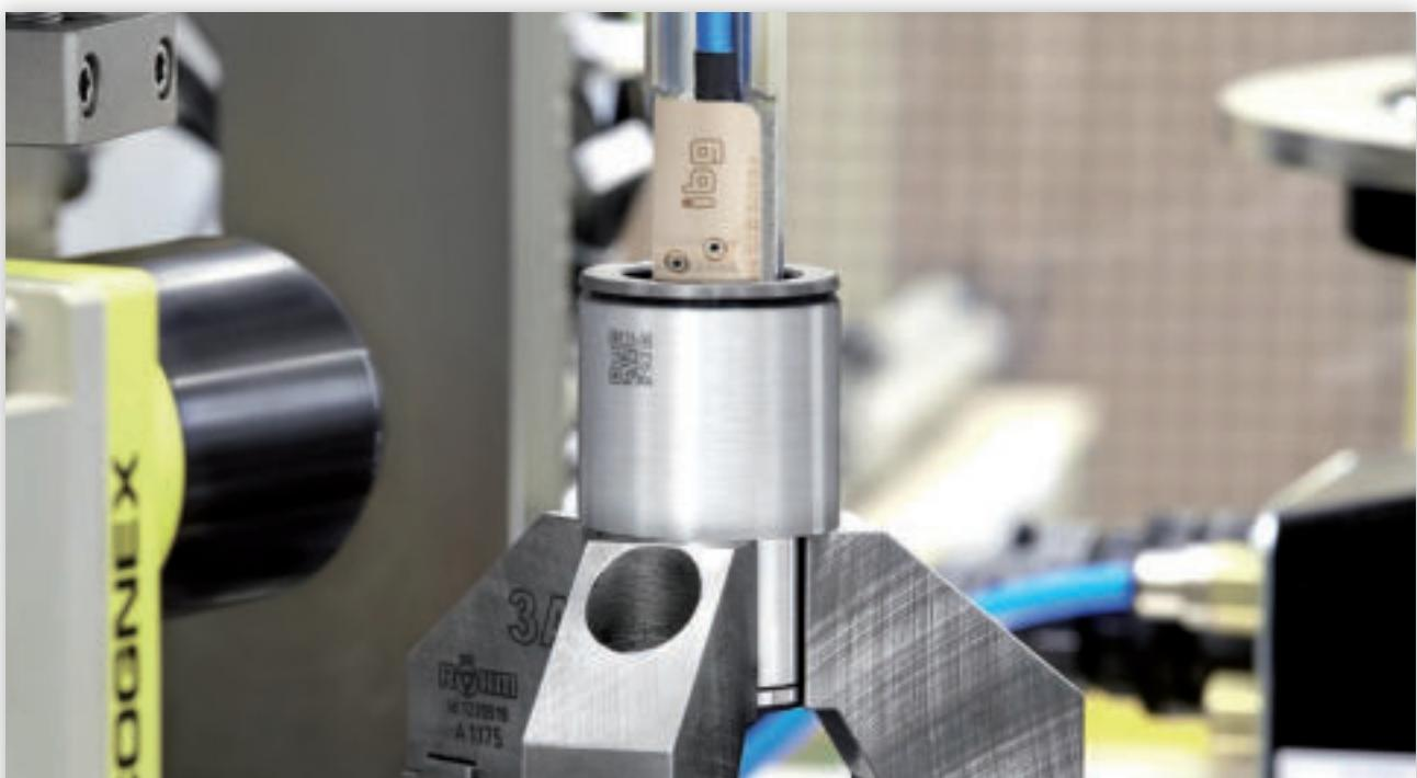
스티어링 너트 역시 ibg자동화 시스템으로 너트 안쪽의 크랙 및 연마 버닝의 검사가 가능합니다. 카메라 검사 시스템을 활용하여 소재의 종류를 알수있는 QR-code를 캡처합니다.
