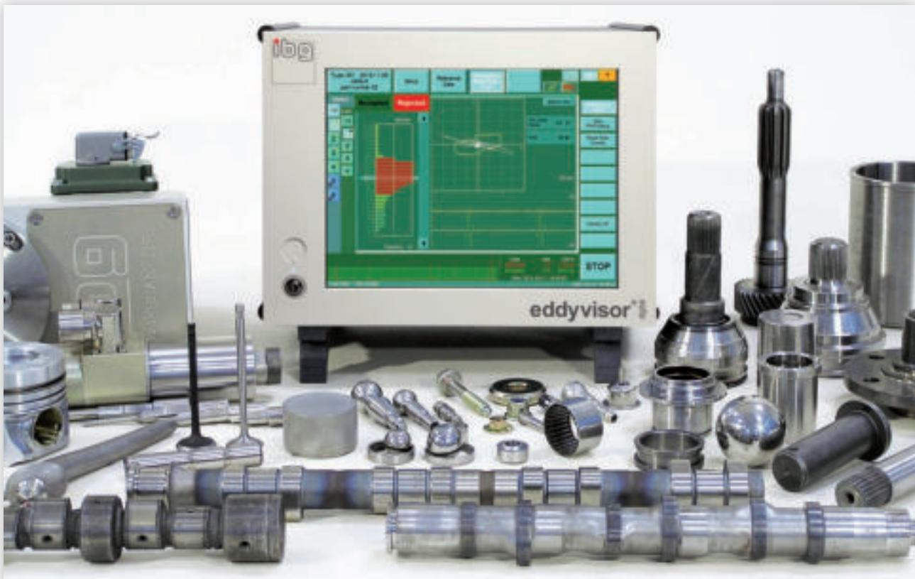
에디바이저는 작고 경제적인 디자인에 최대 16개의 개별적인 고성능의 크랙채널과 최대 32개의 구조검사 채널이 가능합니다. 또한, 에디 커런트기술을 활용한 복잡한 테스트 과정을 ibg사의 높은 신뢰성과 간단한 작동으로 가능 합니다.
