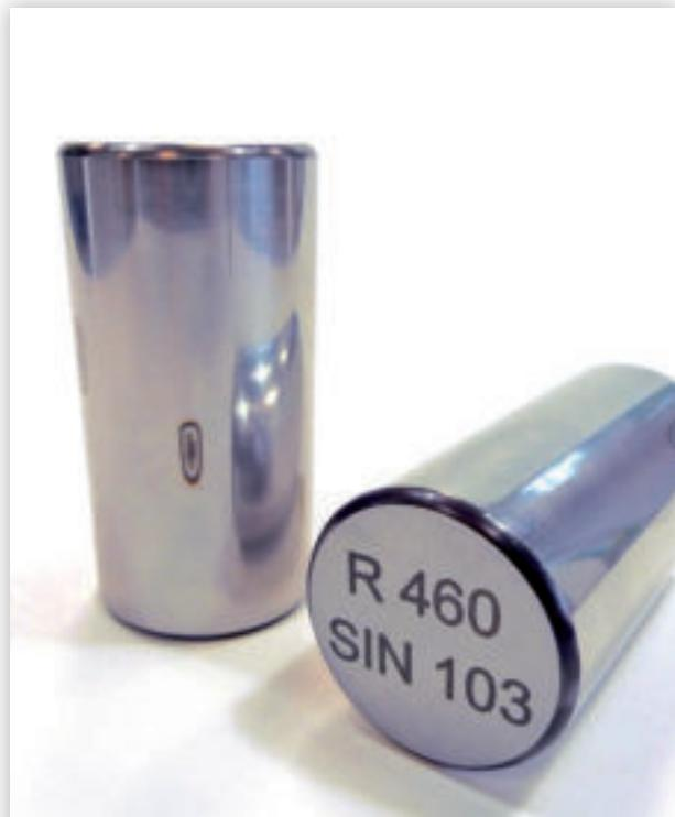
ibg 크랙과 연마 버닝 마스터, EDM크랙들 과 기공등 시뮬레이션 및 연마 버닝의 시뮬레이션을 위한 레이저를 활용한 불량품 제작 ; 미세 잔류 응력 (맨 왼쪽 절단) 및 초기 연화영역 (원쪽).
