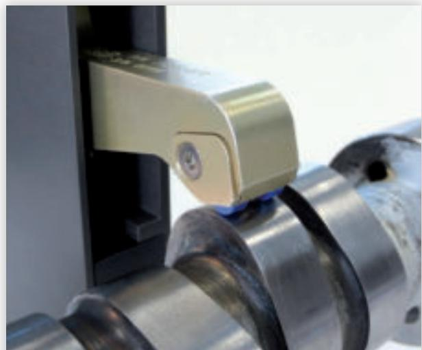
크랙탐상 프로브 박스는 최대300rpm(파트의 균일함에 따라)에서 작동이 적합하며, 캡사프트 로브 같은 특이한 소재, 또는 큰 직경을 가진 소재 검출에 용이 합니다. 또한 세라믹 가이드를 활용하여 작동 수명을 늘렸습니다. 캡사프트 구조 검사시 최적의 제품입니다.
