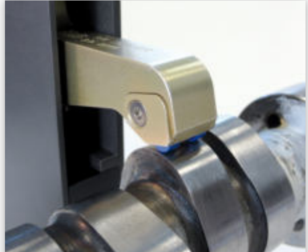
Boîtier de détection de fissure et de brûlure de rectification pour pièces excentriques comme par exemple des cames. Une large gamme de diamètres est couverte ; jusqu'à 300 tr/min (en fonction de la géométrie des pièces) ; patins en céramique pour une longue durée de vie. Sur demande, contrôle structure sur arbres à cames.
