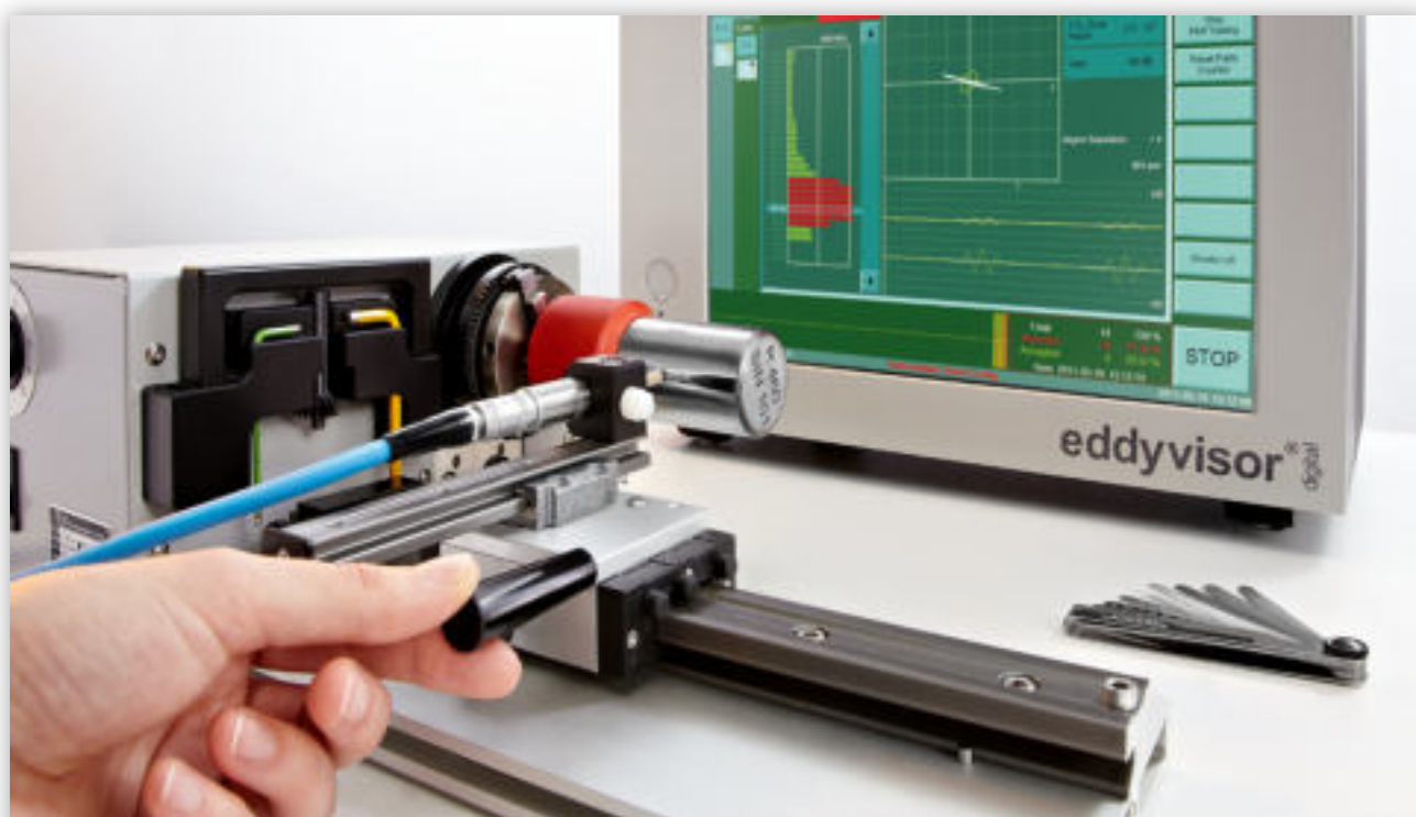
Tour ibg pour tests en laboratoire, études de faisabilité et détection de fissure avec eddyvisor pour petites séries. Vitesse max. 850 tr/min, mandrin jusqu'à un diamètre de 68 mm, avec trigger de position angulaire, déplacement libre de la sonde.
