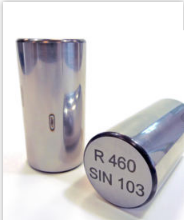
Master ibg de fissures et de brûlures de rectification. Les fissures et les porosités électro-érodées simulent des défauts de surface ouverts. La brûlure de rectification est simulée par un procédé laser. Simple contrainte résiduelle (tout à gauche) et du début de la zone de recuit (au centre).
