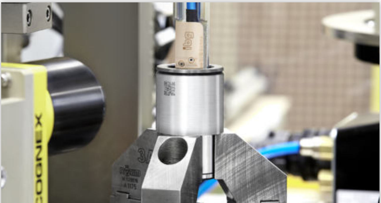
Système ibg de contrôle pour écrou de crémaillère de direction assistée électrique. Détection de fissure et brûlure de rectification sur la piste intérieure. Traçabilité unitaire par capture de QR-code.
