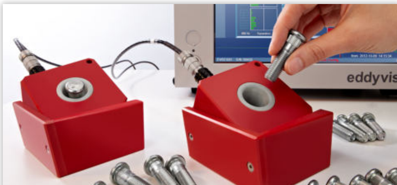
Essais manuels de structure par courants de Foucault en laboratoire
