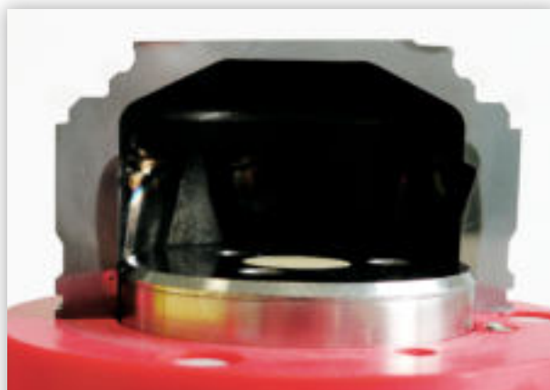
Bobine interne de contrôle structure sur un joint de cardan garantissant la profondeur et le positionnement de la trempe par induction.
