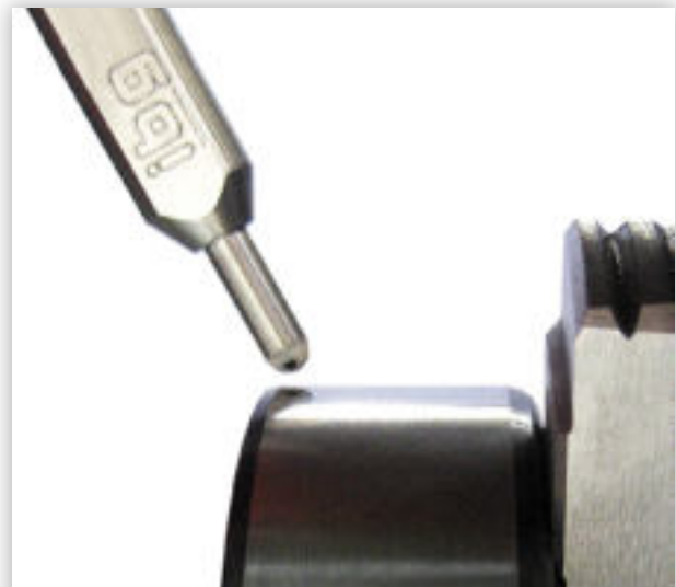
Détection de fissure et brûlure de rectification sur une bague de roulement avec une sonde différentielle ibg de type sphérique X.
