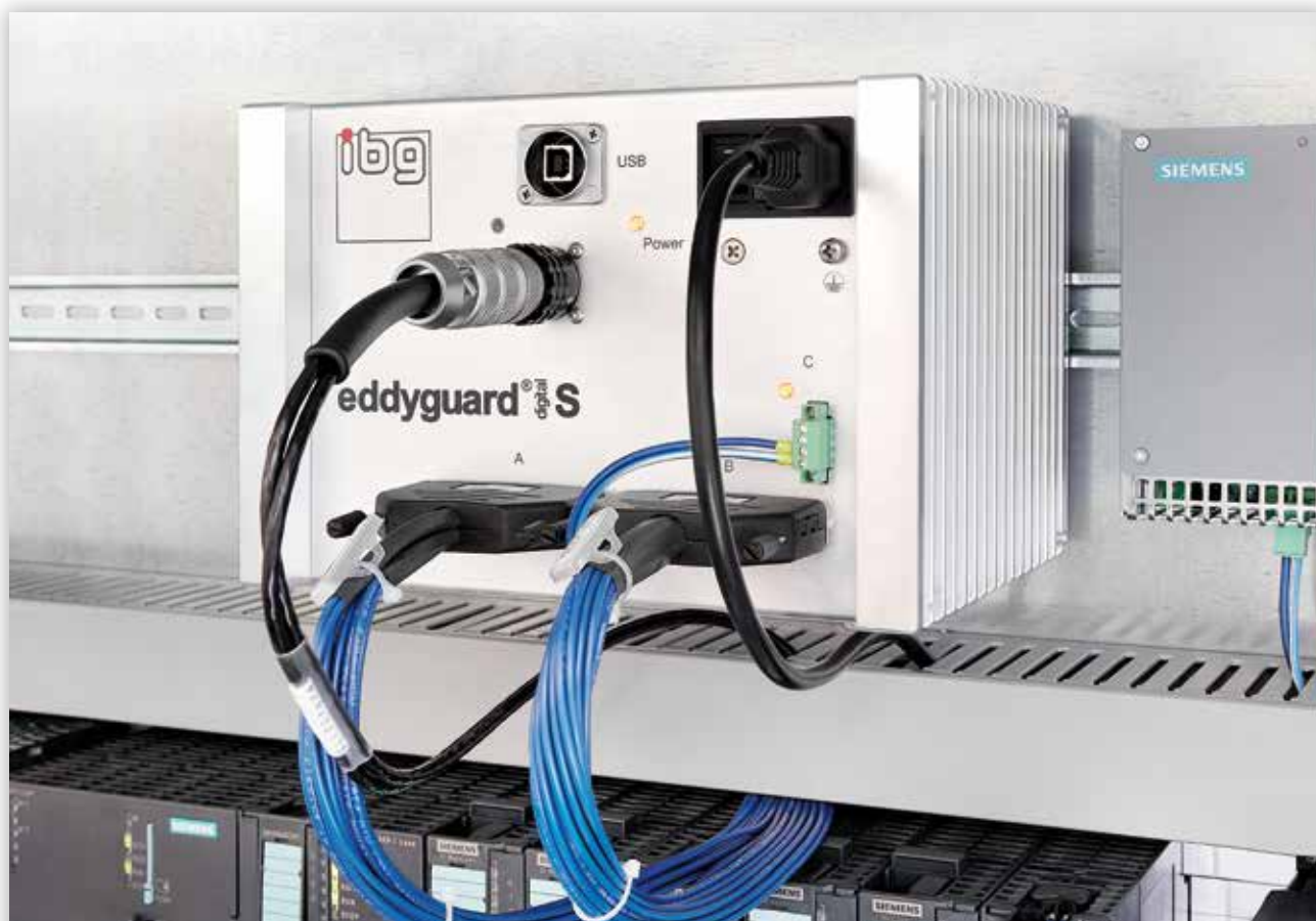
Provedení pro montáž do elektro-rozvaděče: eddyguard S ve vestavěném zapojení.
